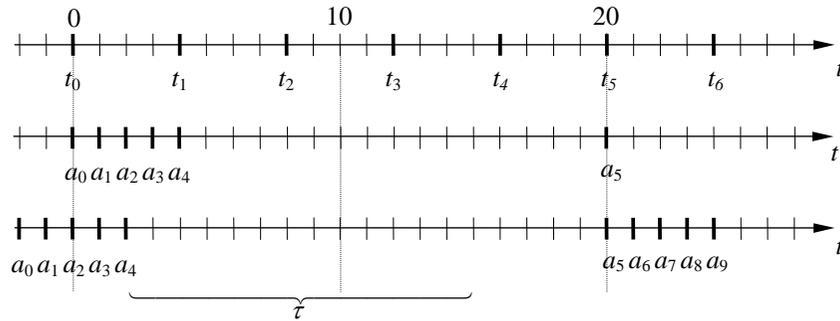
– Dichter Strom von Bursts der Längen 4,2,1,1,5,2
